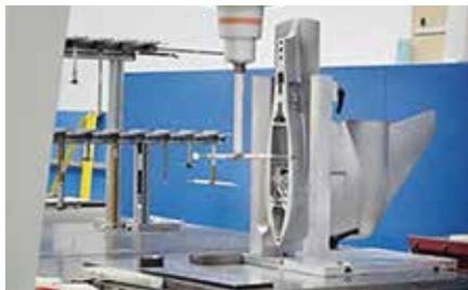
I campioni dei componenti provenienti dalla catena di montaggio vengono accuratamente controllati per garantirne la conformità con il progetto originale.
