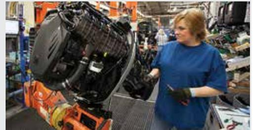
Dispositivi di montaggio ergonomici consentono ai tecnici Verado di concentrarsi sui dettagli, motore dopo motore, per l'intero turno di lavoro.
