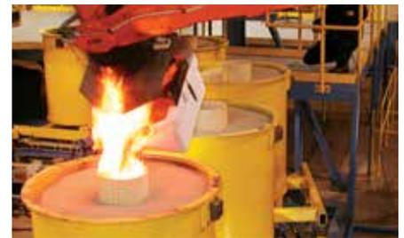
L'esclusivo processo Mercury di colata a schiuma persa sotto pressione, permette di produrre in modo molto semplice fusioni complicate, risultanti più leggere ed affidabili.
