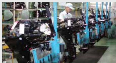
Dopo il collaudo, i tecnici installano l'elica e la calandra. In seguito vengono eseguiti anche i controlli finali di qualità per assicurare alla nostra clientela il massimo in termini di affidabilità.
